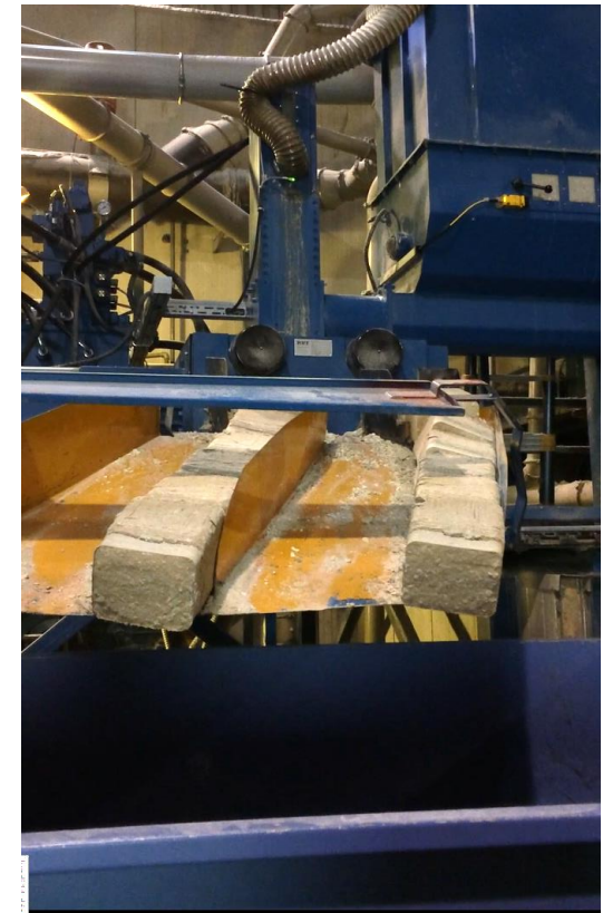
Sortie du polyuréthane compacté en briquettes pour une valorisation énergétique
