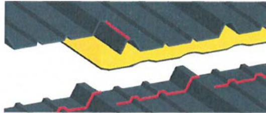
▲ Figure 30: Compléments d'étanchéité au droit des jonctions de panneaux
